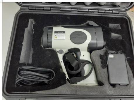
紅外線溫度測定器/紅外線溫度
