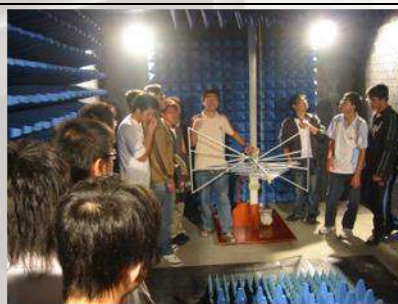
電波隔離暗室
